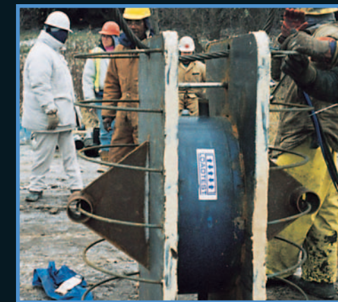
O-cell을 사용한 분할 실린더의 수평 압반 변형계수 시험
