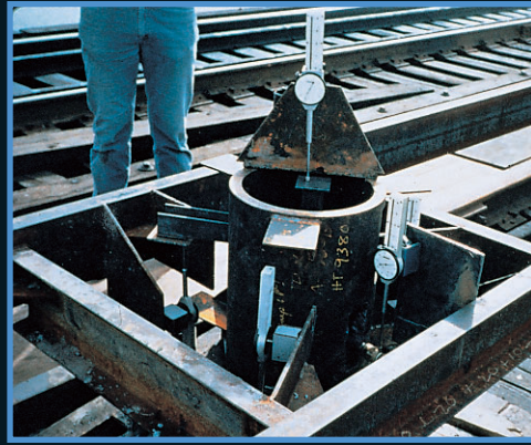
O-cell을 사용한 강관 말뚝 재하 시험
