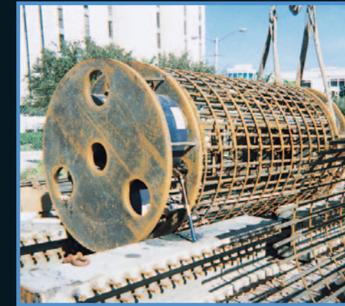
여러 개의 O-cell을 사용한 대용량 시험
